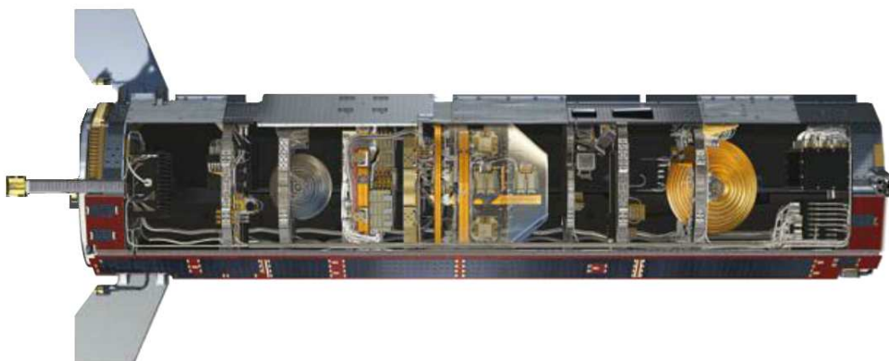
Spaccato del satellite GOCE, dove al centro è piazzato il gradiometro (con masse di platino e pannelli di carbonio)
