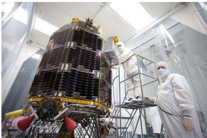
LADEE in fase di allestimento al NASA's Ames Research Center, Moffett Field, California, e, a destra, immagine della sonda con l'indicazione degli strumenti. Credit: NASA Ames
