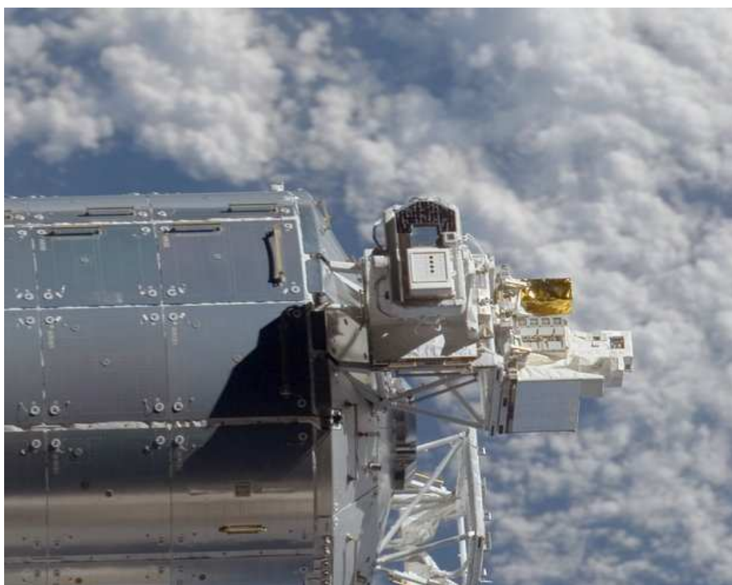
Il telescopio solare per la Stazione Spaziale Internazionale e, sotto, la sua collocazione sul modulo Columbus della ISS (Credit: ESA)
