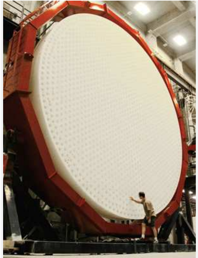
Il primo dei sette specchi del GMT appena estratto dalla fornace. Lo scienziato sta ispezionando i fori di ventilazione, necessari per un corretto funzionamento del telescopio. Crediti: Ray Bertram/University of Arizona
