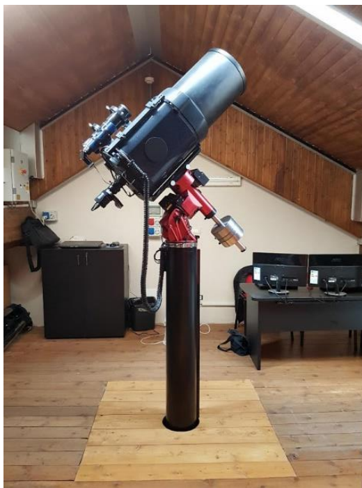
RCX400 Meade, modificato, su 10 Micron GM2000 QCI, attivo in SPE.S.-Specola Segusina dal 2016 al 2023.
