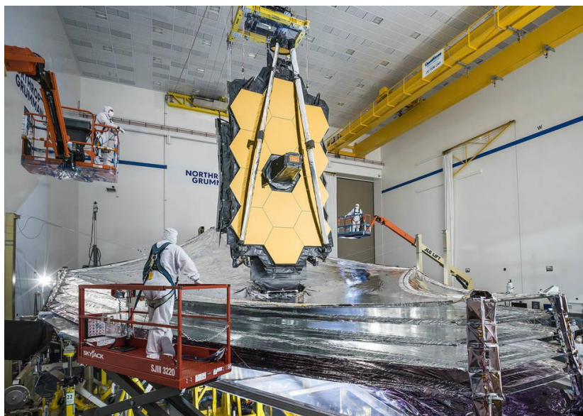
I test finali di dispiegamento e tensionamento dello schermo solare del James Webb Space Telescope sono stati completati nel dicembre 2020. Crediti: NASA/Chris Gunn
