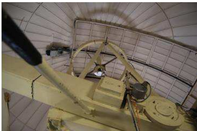
Il telescopio infrarosso Carlos Sanches (TCS), la cui cupola è incredibilmente piccola per lo strumento da 1.55 m, il più datato dell'OT (anni '70); durante le osservazioni il telescopio è pilotato in remoto ma l'accesso al telescopio è ancora necessario per azionare i meccanismi analogici
