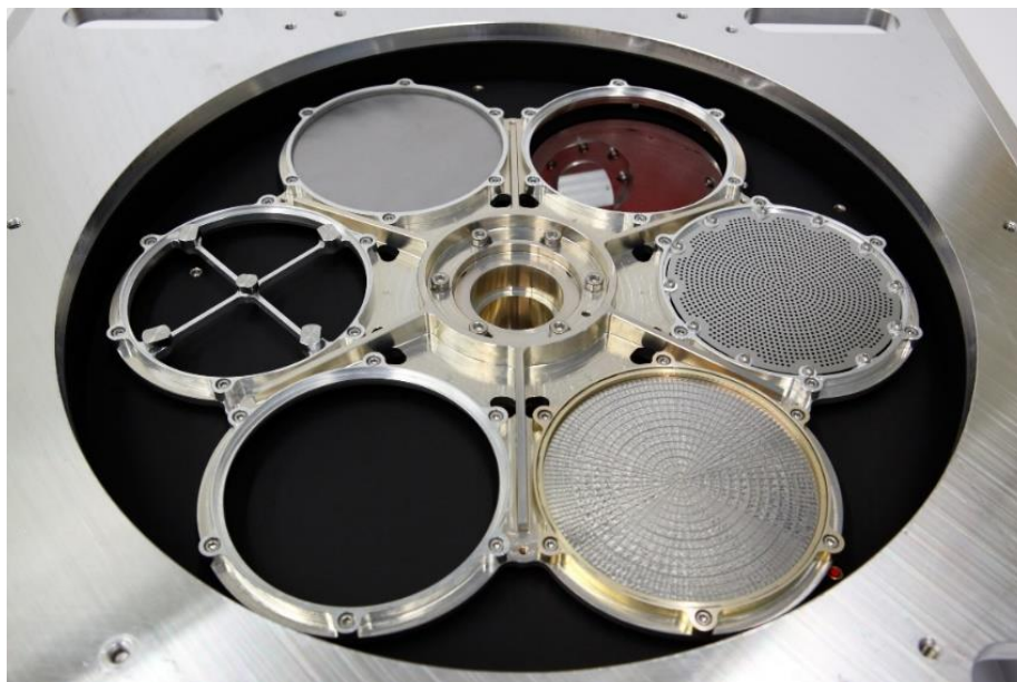
La ruota portafiltri dello strumento Resolve. Crediti: Sron
