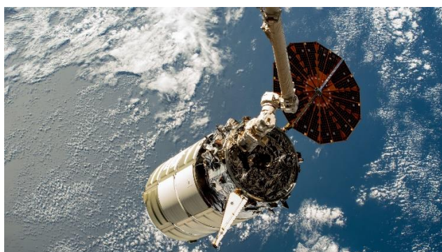
21 aprile 2023: il cargo spaziale Cygnus di Northrop Grumman afferrato dal braccio robotico Canadarm2, e (a destra) rilasciato mentre la Stazione Spaziale Internazionale orbita 262 miglia sopra l'isola spagnola di Maiorca nel Mar Mediterraneo. Crediti: NASA
