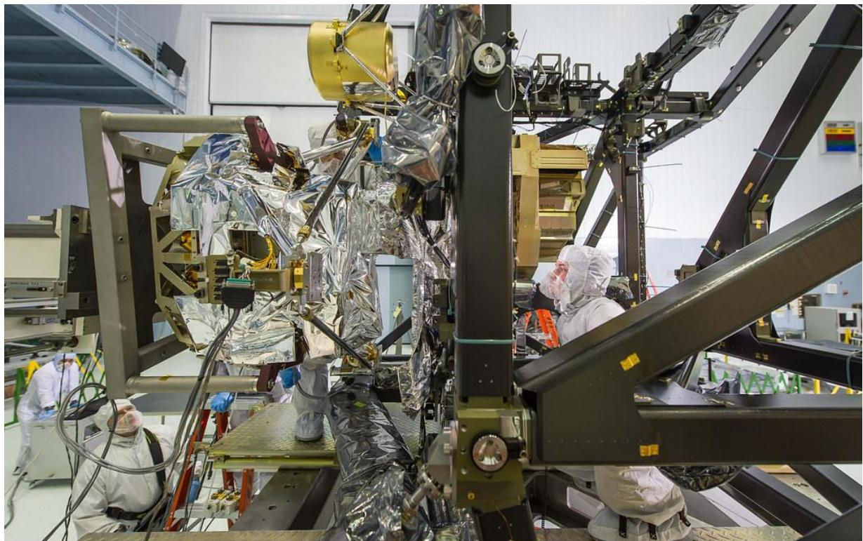
Nella camera bianca del Goddard Space Flight Center della NASA a Greenbelt gli ingegneri stanno controllando che MIRI (Mid-Infrared Instrument) sia posizionato con precisione nell'ISIM (Integrated Science Instrument Module).
