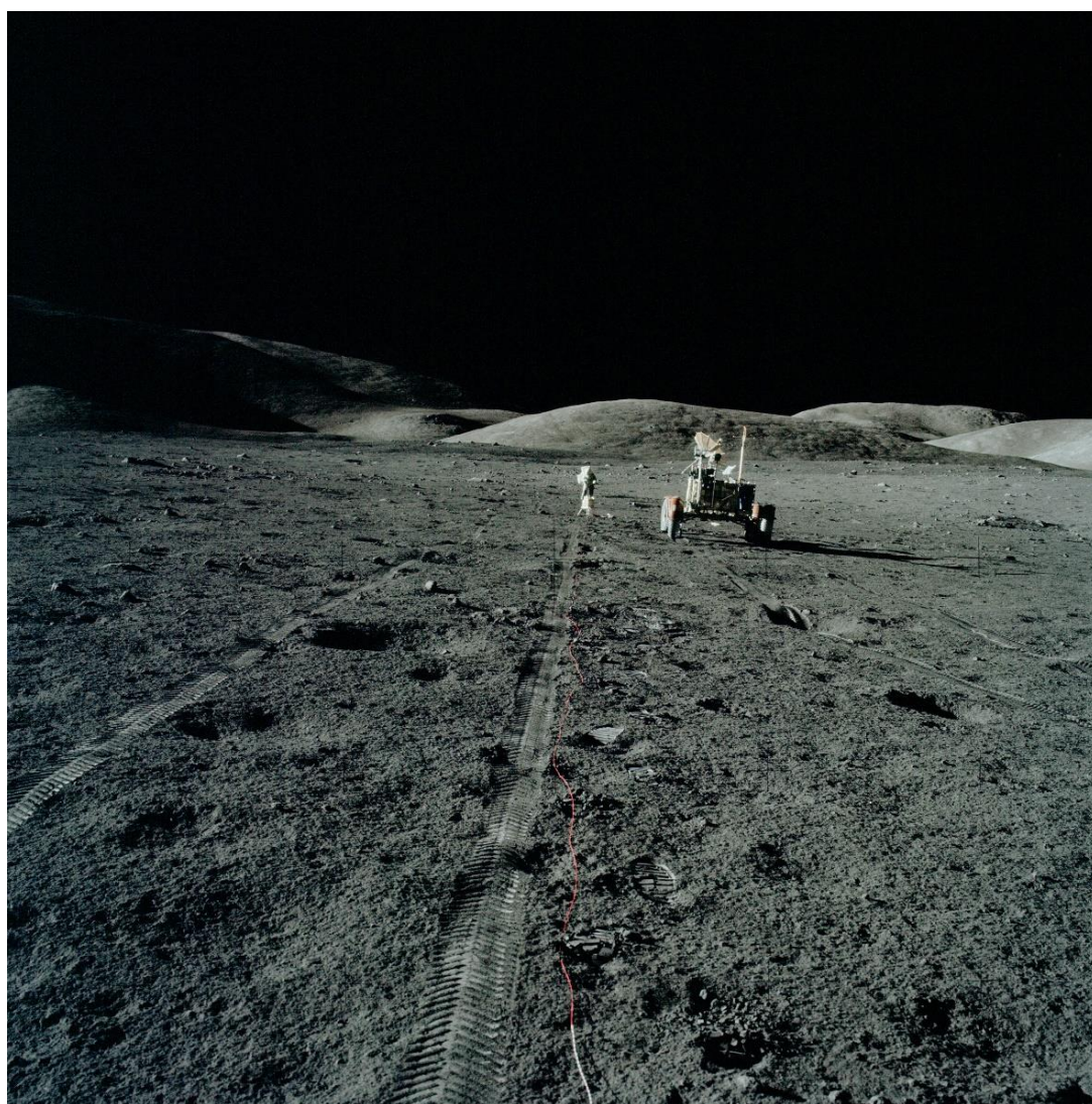
Schmitt, ripreso da Cernan, durante il dispiegamento di un cavo di 35 m dell'Apollo Lunar Surface Experiments Package, o ALSEP. (NASA)
