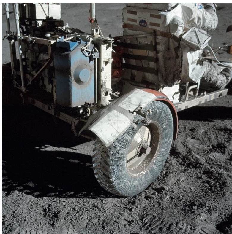
In alto, Cernan accanto al Lunar Rover e, sotto, la riparazione estemporanea, con alcune carte lunari, di un parafrangente danneggiato. (NASA)
