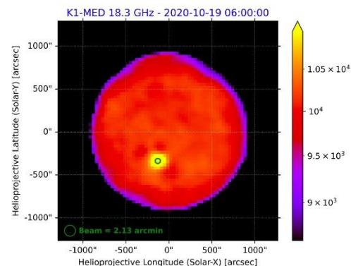
Ottenerne per la prima volta immagini radio-solari calibrate con precisione migliore del 3 per cento nella banda 18-26 GHz è un primato di SunDish. Un complesso sistema di analisi dati sviluppato ad hoc consente di identificare e analizzare automaticamente flussi e spettri delle regioni attive presenti sul disco solare, alla ricerca di “sintomi” che possono preludere a importanti brillamenti.
