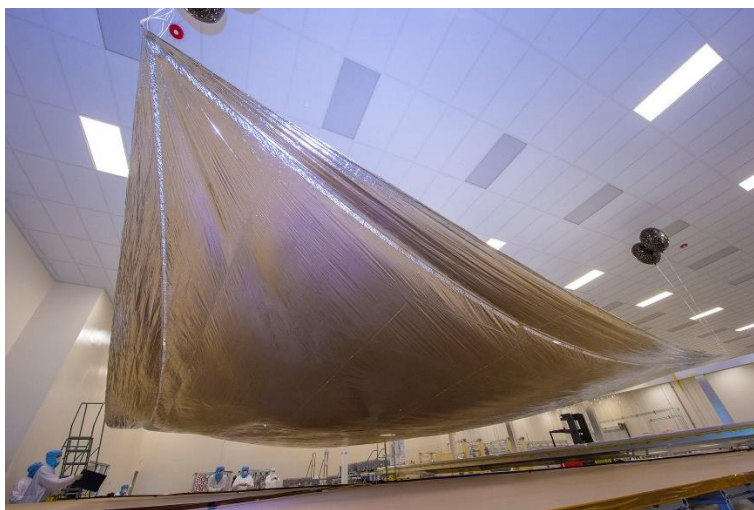
La vela solare della missione Nea Scout completamente dispiegata durante la fase di preparazione della missione. Crediti: Nasa
