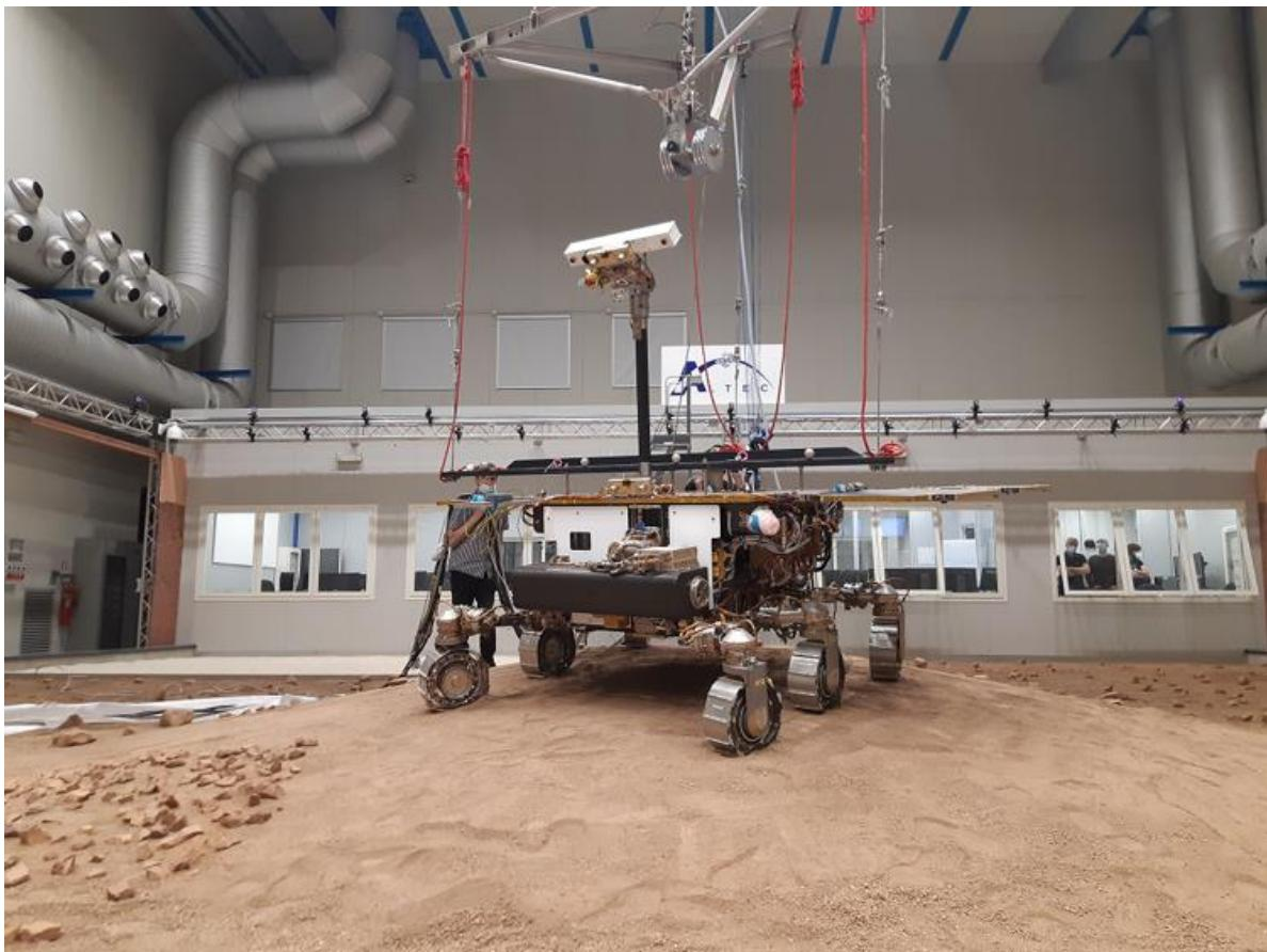
Il modello ingegneristico del rover marziano del programma ExoMars in ALTEC, a Torino, con il suo sistema di sospensione per approssimare la minore gravità del pianeta, avendo influenza sull'attrito delle ruote durante le manovre simulate. Crediti: ESA/ASI/ALTEC
