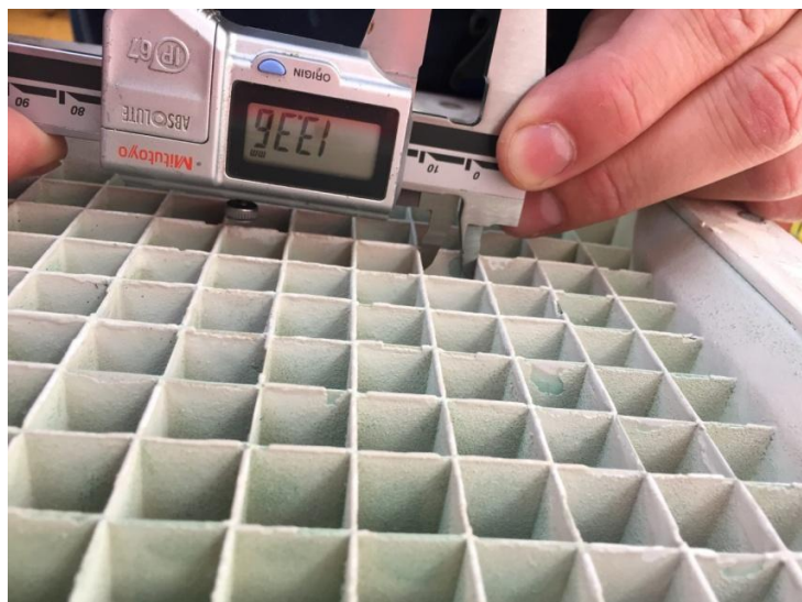
Misure di precisione del collimatore nei laboratori dell'Esa a Estec. Crediti: E. Kuulkers
