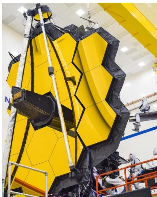
Il James Webb Space Telescope (JWST) all'interno della camera bianca della Northrop Grumman Corporation mentre viene sottoposto al test di dispiegamento dello specchio primario in condizioni di lancio simulato.
