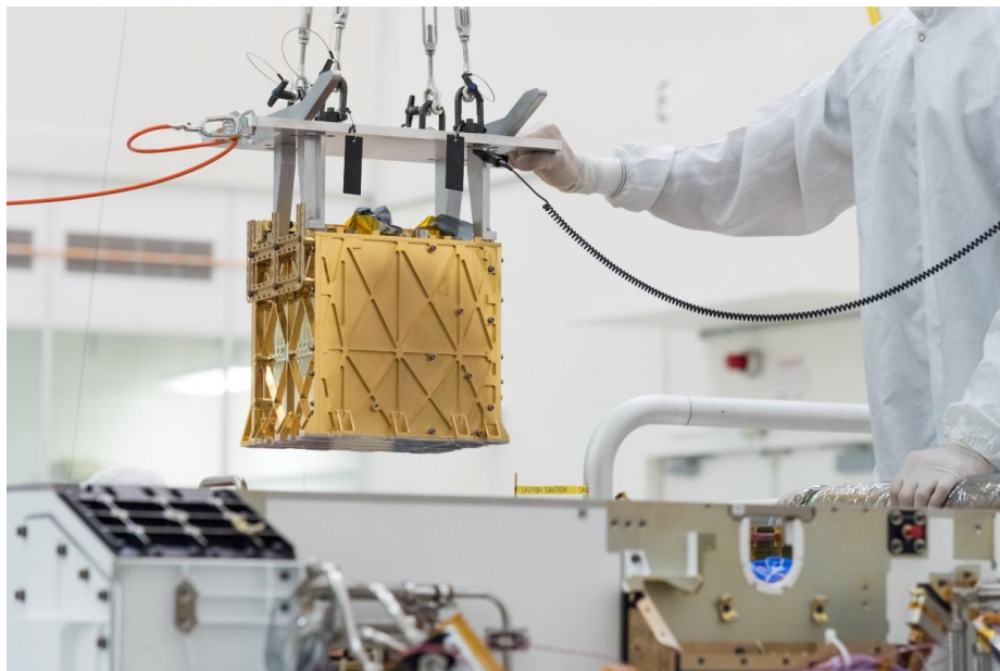
Lo strumento Mars Oxygen In-Situ Resource Utilization Experiment (MOXIE) mentre viene inserito nel rover Perseverance al Jet Propulsion Laboratory. Crediti: NASA/JPL-Caltech
