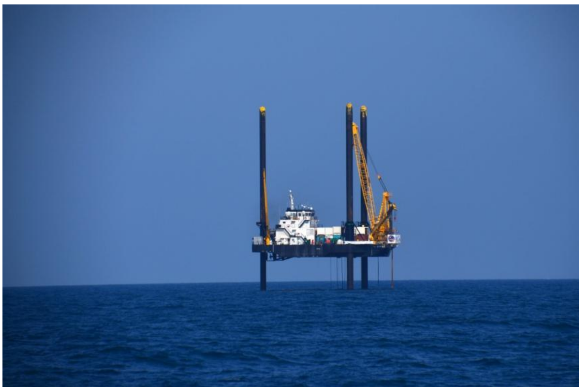
La nave oceanica Myrtle mentre, nel 2016, effettua su tre gambe i carotaggi sul fondo oceanico in corrispondenza del cratere Chicxulub, nella penisola dello Yucatan, Messico. Crediti: The University of Texas Jackson School of Geosciences/Chris Lowery
