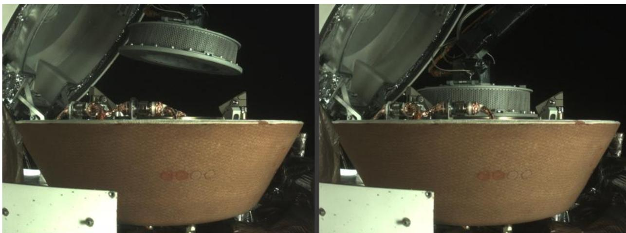
A sinistra la testa del raccoglitore di OSIRIS-REx che si avvicina alla capsula di ritorno del campione (SRC) dopo che il braccio del meccanismo di acquisizione dei campioni Touch-and-Go l'ha spostata nella posizione corretta per l'acquisizione. A destra la testa del collettore fissata sull'anello di cattura nell'SRC. Entrambe le immagini sono state catturate dalla fotocamera StowCam. Crediti: NASA/Goddard/University of Arizona/Lockheed Martin
