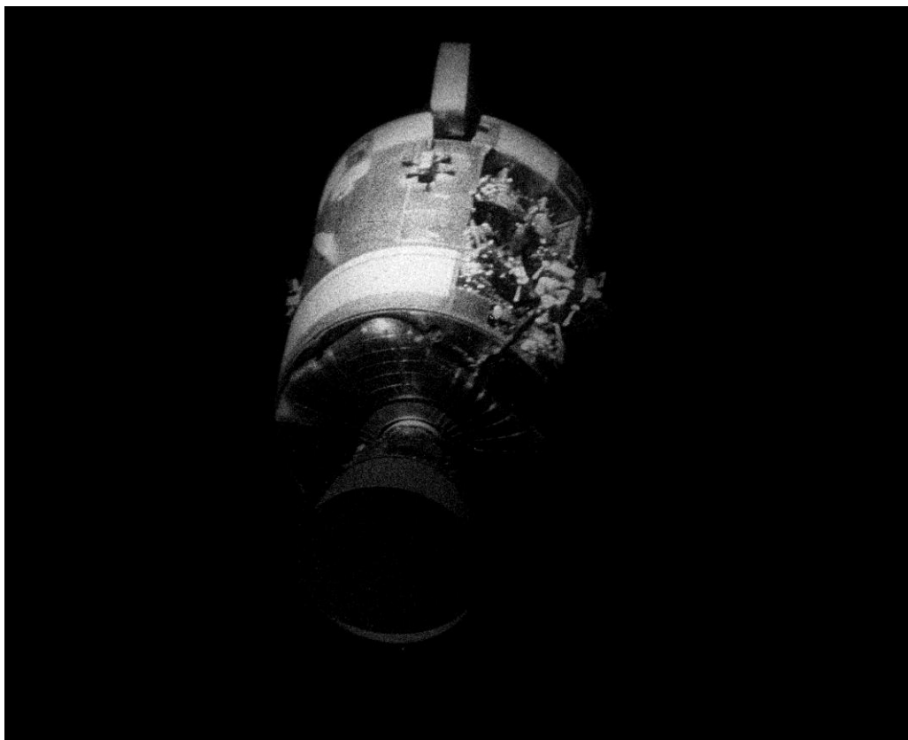
Il danno sul modulo di servizio di Apollo 13 ripreso prima del rientro nell'atmosfera terrestre. (NASA)
