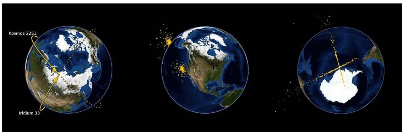
Collisione tra Kosmos 2251 e Iridium 33: da sinistra a destra, il momento della collisione, la posizione dei detriti dopo 20 minuti e dopo 50 minuti. Fonte: Ruediger Landmann, Wikipedia.
