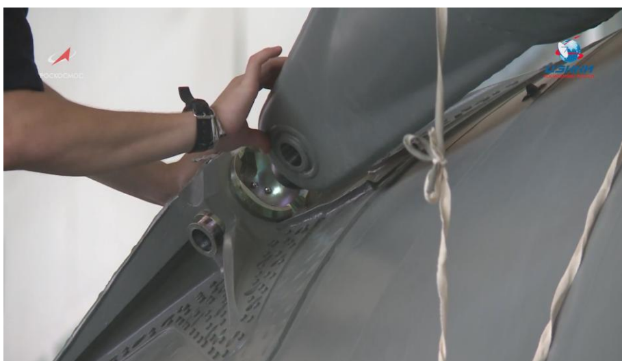
L'apice dei booster laterali del razzo Soyuz FD, un semplice grosso perno (Credit: ROSCOSMOS)
