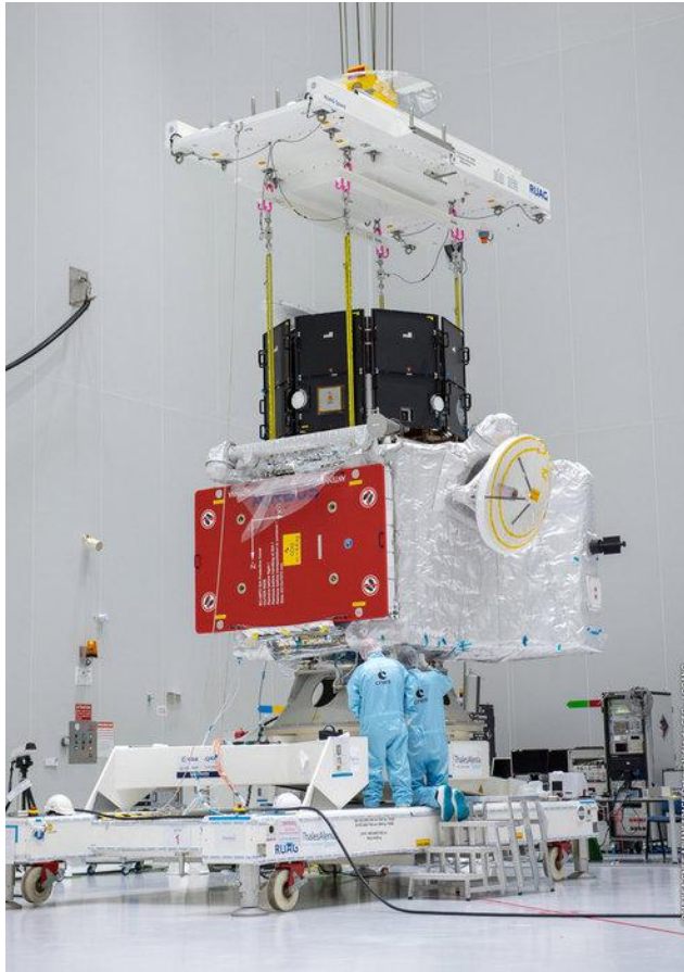
L'aggancio dei due moduli (a sinistra) e il 'fit check' (a destra). Credit: ESA/CNES/Arianespace/Optique video du CSG - J. Odang
