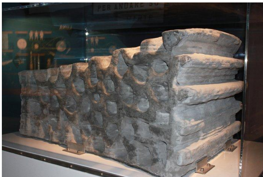
Blocco da 1,5 tonnellate prodotto come dimostrazione di tecniche di stampa 3D usando il suolo lunare. Il design si basa su una struttura vuota a cellule chiuse, che ricorda le ossa degli uccelli, per dare una buona combinazione di forza e peso. Crediti: ESA
