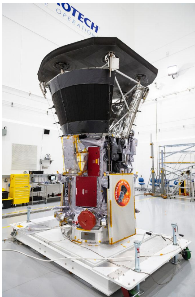
La sonda Parker Solar Probe fotografata il 6 luglio scorso presso il centro Astrotech Space Operations a Titusville, in Florida, dopo l'installazione del suo scudo termico. Crediti: NASA/Johns Hopkins APL/Ed Whitman
