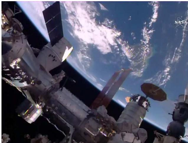
Il cargo SpaceX Dragon, a sinistra, attraccato al modulo Harmony della ISS. Nell'immagine si vede anche il cargo Cygnus con i pannelli solari circolari e la navicella Soyuz TMA-19M. Dragon è stato lanciato l'8 aprile 2016 alle 22:43 CEST con un Falcon 9, il cui primo stadio è poi atterrato regolarmente su una piattaforma marina.
