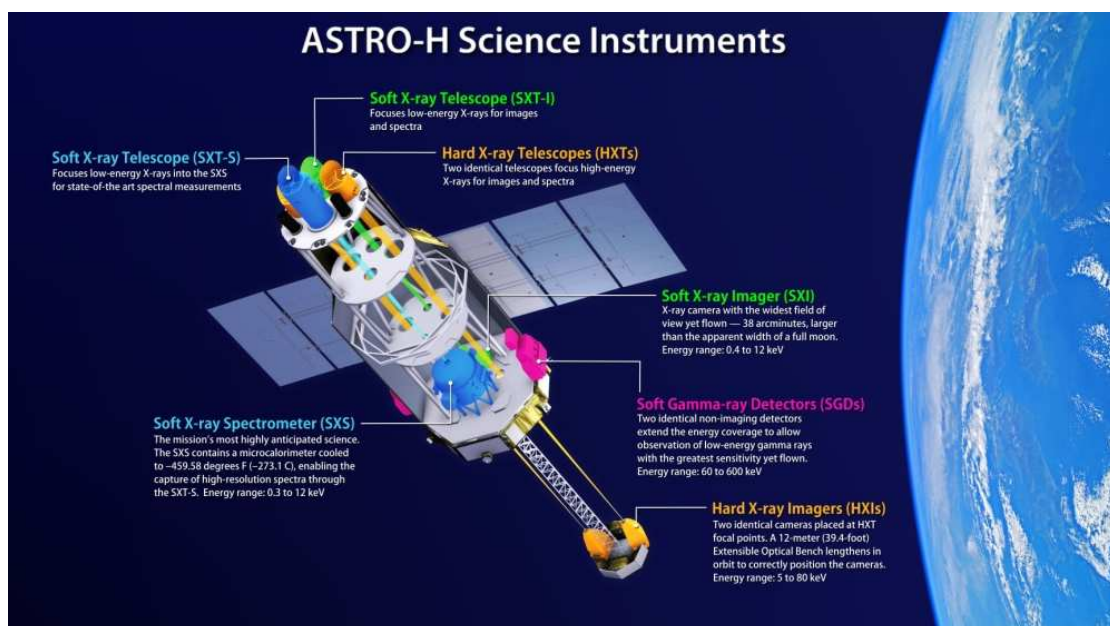
Strumentazione del satellite ASTRO-H. Crediti: JAXA / NASA's Goddard Space Flight Center
