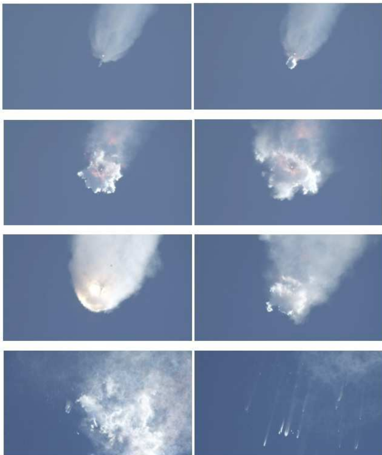
Sequenza del filmato (da http://spaceflightnow.com/ ) dell'esplosione in volo del razzo SpaceX/Falcon 9: forse la causa dell'incidente è la rottura ad alta pressione del serbatoio dell'ossigeno liquido del secondo stadio del lanciatore.
